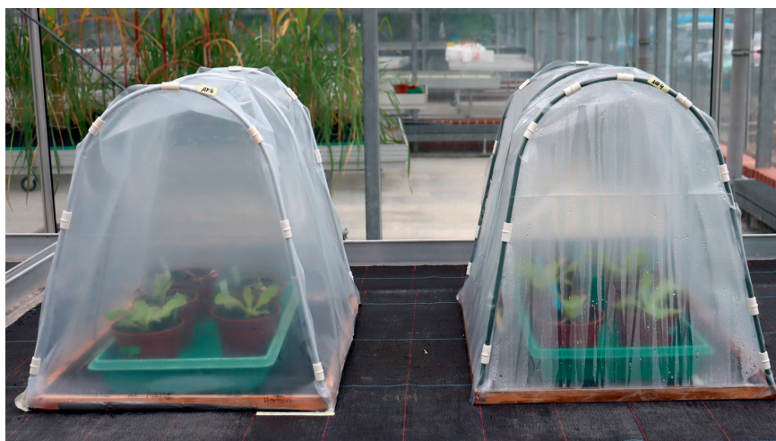
Bild 5. Folientunnelexperimente mit Salatpflanzen: Gut zu sehen ist der Effekt der Antifog-Ausstattung. Bei den Folien ohne entsprechende Additive bilden sich deutlich sichtbare Tropfen (rechts).
